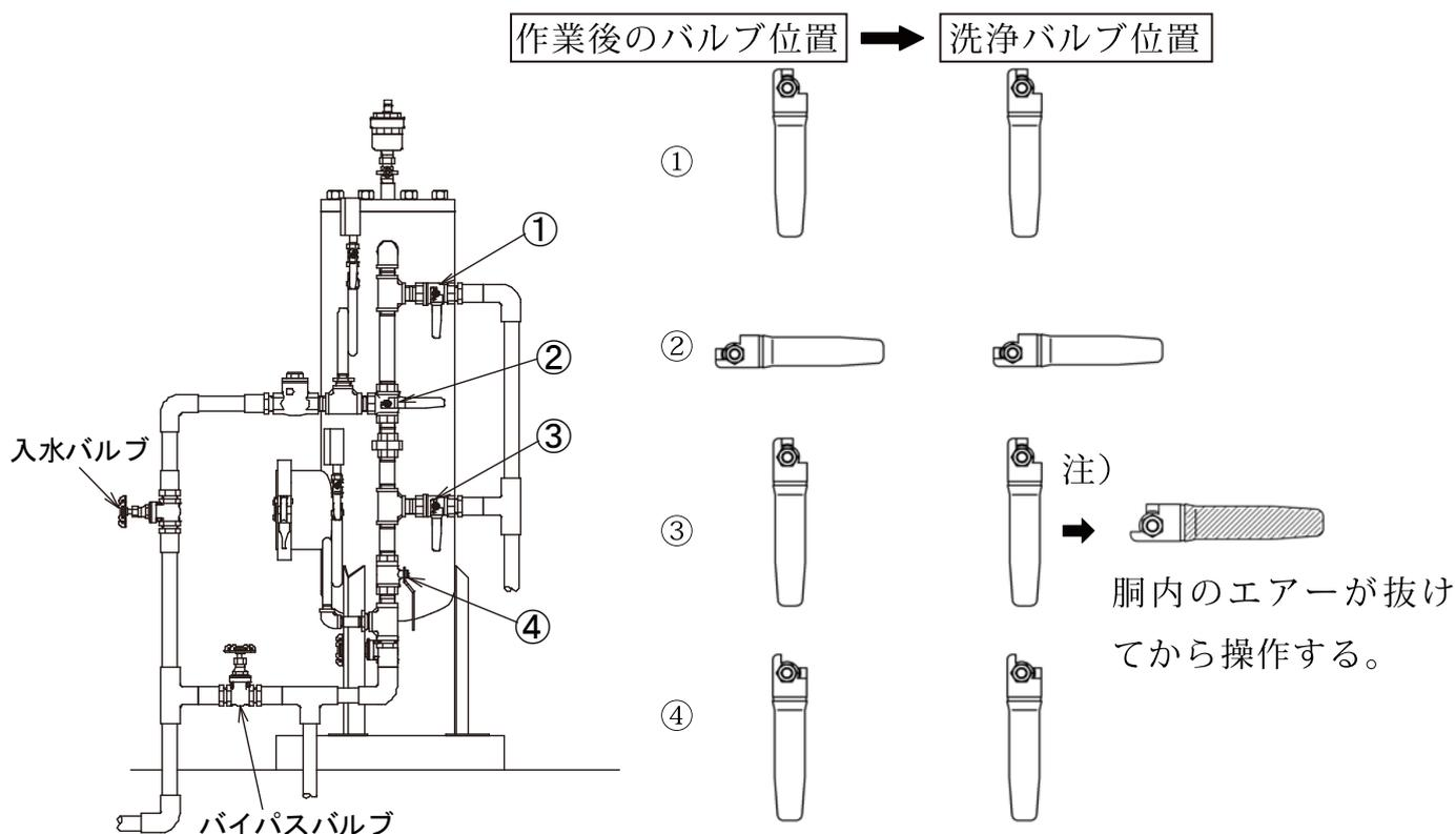
注) 洗浄の際、給水するといったん上部エア抜きからエアが抜けます（この時の③のバルブ位置は作業後のバルブ位置です）。エアの抜ける音が止まってから1～2分お待ちください。
