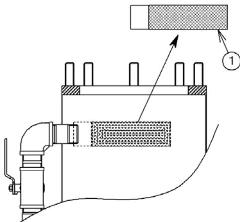
1. ①のストレーナーを外し（ネジ式）、布テープで胴内のネジ込み穴をふさぐ。
