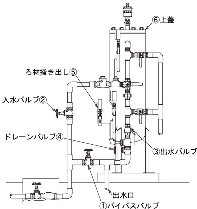
8. ある程度ろ材が掻き出し終わったら、②の入水バルブを少し開き、上部より水を入れて胴内のろ材をきれいに洗い流す。
