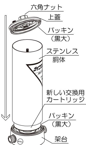
(6)上蓋の中心穴にセンター軸を通して、六角ナットを手で回して締め付けた後、簡易スパナで締めてください。
