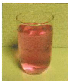
塩素試薬を入るとピンク色に変色した水道水
